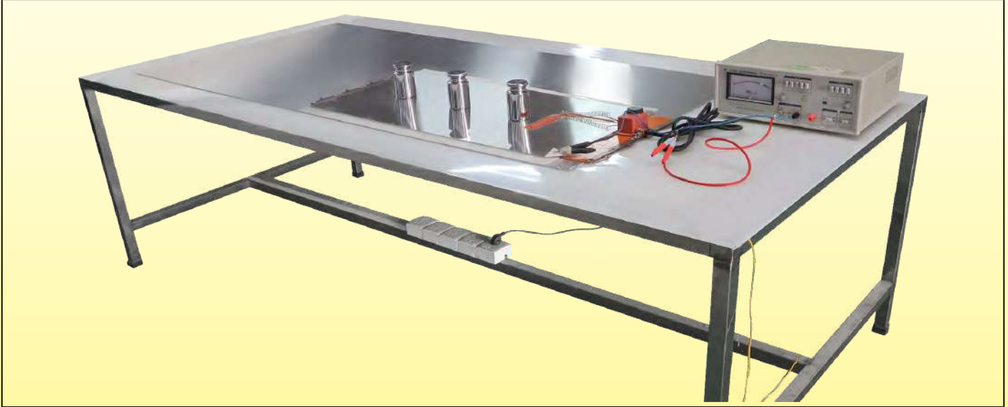
อุปกรณ์สำหรับวัดความต้านทานของฉนวน ค่าที่วัดได้จะมากกว่า 0.1 กิโลโอห์ม เสมอ
