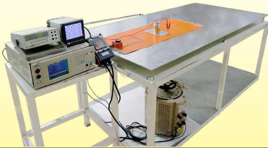
เครื่องมือวัดสำหรับการรั่วไหลของกระแสรวมที่สภาวะร้อน
