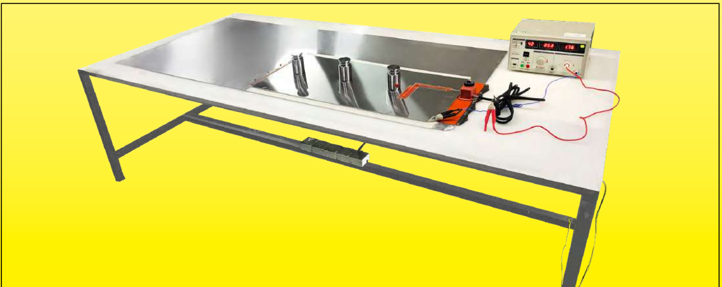
เครื่องมือวัดสำหรับการรั่วไหลของกระแสรวมที่สภาวะเป็น
