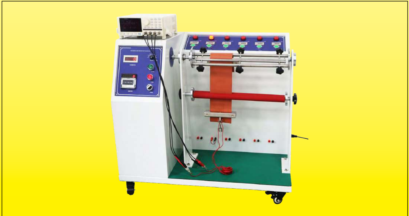
เครื่องทำความร้อนแบบซิลิโคนที่ยืดหยุ่นในระหว่างการทดสอบการงอ
